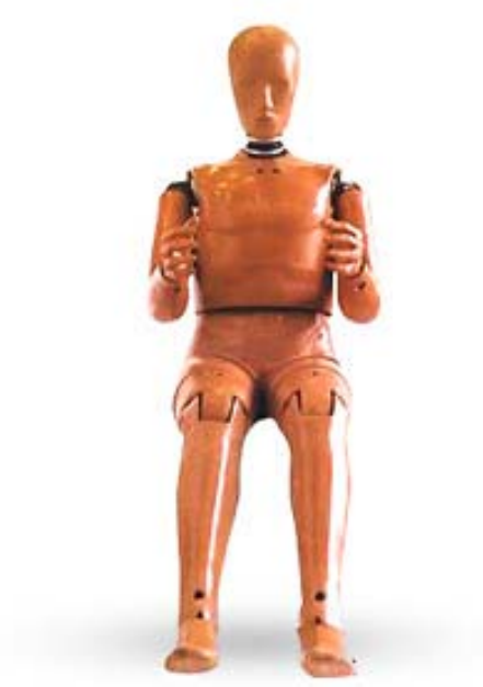
Hybrid III: Samler data fra frontkollisjon
