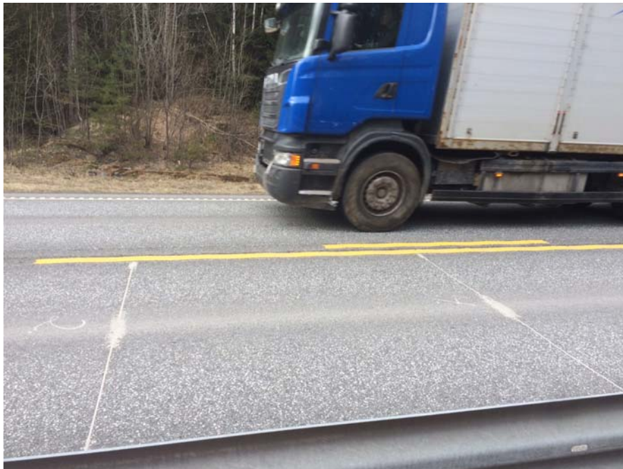
Piezoelektriske kabler på E18 Dørdal
