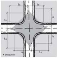
Figur C.22: Siktkrav i uregulerte X-kryss
