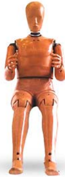
Hybrid III: Samler data fra frontkollisjon
